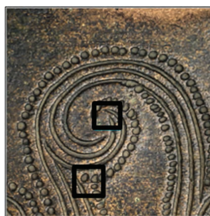
16. a kép: A pásztázó mikroszkóp segítségével 2x2 mm-es elemtérkép felvételére is sor került a hajdúsámsoni kard pengéjének díszítésén.
